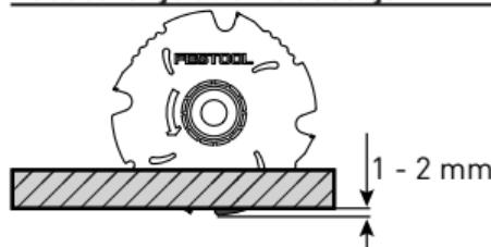
Podešavanje dubine sečenja prema debљini predmeta obrade- razmak zubaca 1 - 2 mm.
