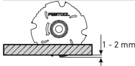
Ustawianie głębokości cięcia zgodnie z grubością elementu obrabianego – wystawianie zębów 1 - 2 mm.
