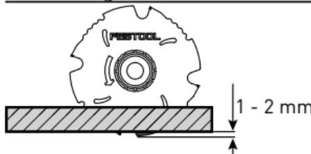
Nastavite globino reza glede na debelino obdelovanca – izstopanje zob 1–2 mm.
