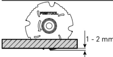
Nastavte hloubku řezu podle tloušťky obrobku – přesah zubů max. 1 - 2 mm.
