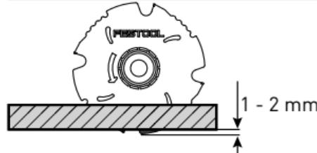
Régler la profondeur de coupe selon l'épaisseur de la pièce – dépassement des dents 1 - 2 mm.
