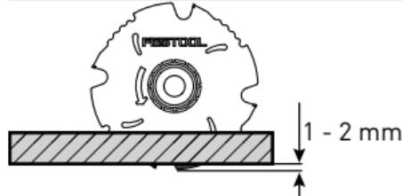
Отрегулируйте глубину реза под толщину заготовки — пила должна выступать над заготовкой на 1—2 мм.
