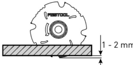
Ajustar la profundidad de corte según el espesor de la pieza de trabajo; rebase de diente de 1-2 mm.
