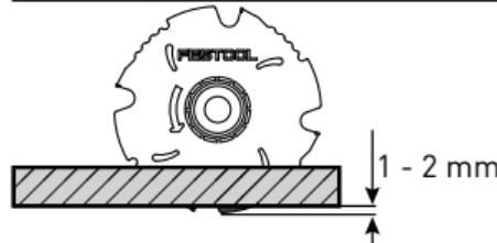
Ajustar a profundidade de corte de acordo com a espessura da peça a trabalhar – sobressaliente dos dentes 1 - 2 mm.
