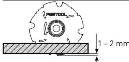
Ρυθμίζετε το βάθος κοπής σύμφωνα με το πάχος του επεξεργαζόμενου κομματιού - προεξοχή των δοντιών 1 - 2 mm.
