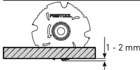
Regolare la profondità di taglio in base allo spessore del pezzo in lavorazione – sporgera denti max. 1 - 2 mm.
