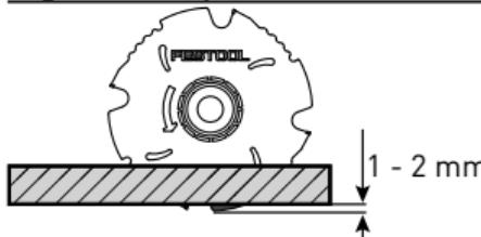
Noregulējiet zāgēšanas dzīlumu atbilstoši sagataves biezumam – zobu izvirzījums ir 1 - 2 mm.
