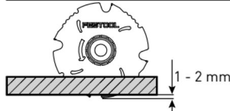
根据工件厚度调整切割深度 – 锯齿最多突出 1 - 2 mm。
