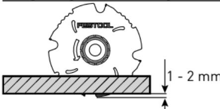
Namjestite dubinu rezanja prema debljini izratka – stršenje zupca 1 - 2 mm.
